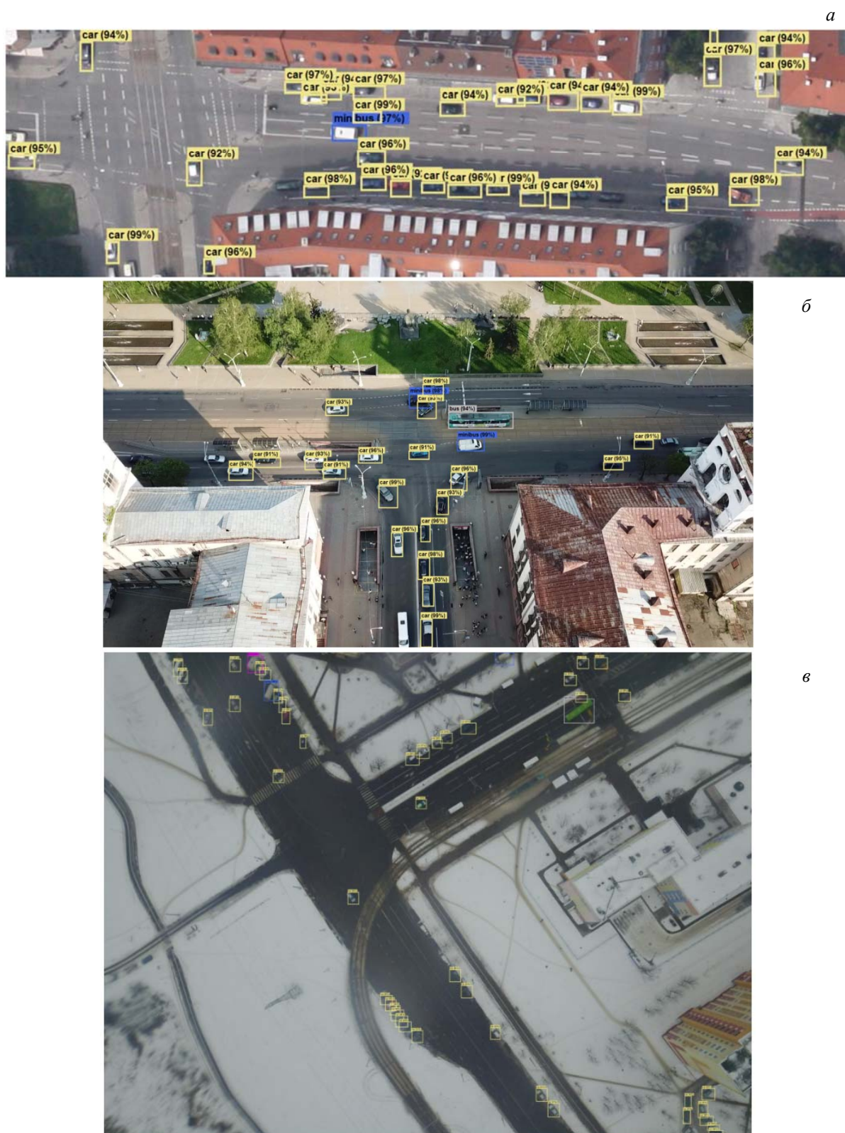
Рис. 3. Результаты обнаружения и классификации транспортных средств на изображениях, снятых под углом 90^\circ (а) и 70^\circ (б) в летний период; снятых под углом 90^\circ в зимний период (в)
