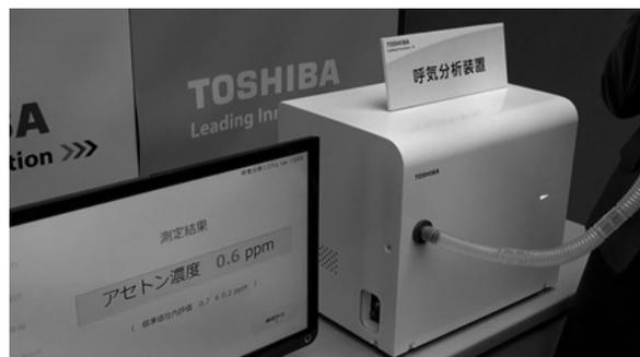
Рис. 11. ККЛ-газоанализатор фирмы Toshiba [84, 85]
