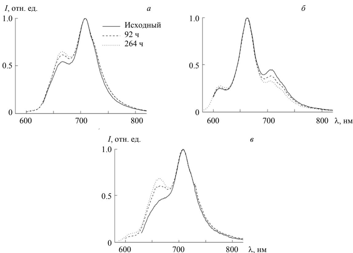
Рис. 3. Временная эволюция спектров флуоресценции  $H_2T(3-N-MPIR)P$  при возбуждении на  $\lambda_{\text{возб}} = 514$  (а), 554 (б) и 580 нм (в); спектры нормированы на пиковую интенсивность
