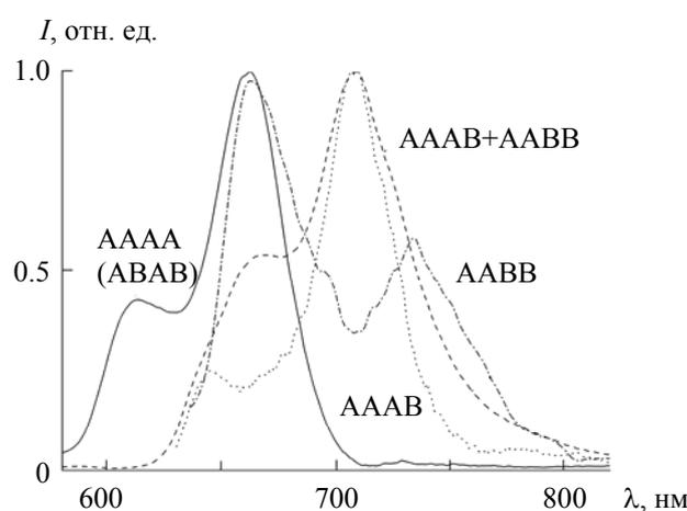
Рис. 5. Нормированные на пиковую интенсивность индивидуальные спектры флуоресценции атропизомеров  $H_2T(3-N-MPIr)P$  в равновесном растворе
