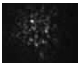
Рис. 4. Снимок луча ИК ККЛ, прошедшего через фазовую пластину, имитирующую атмосферную турбулентность [70]
