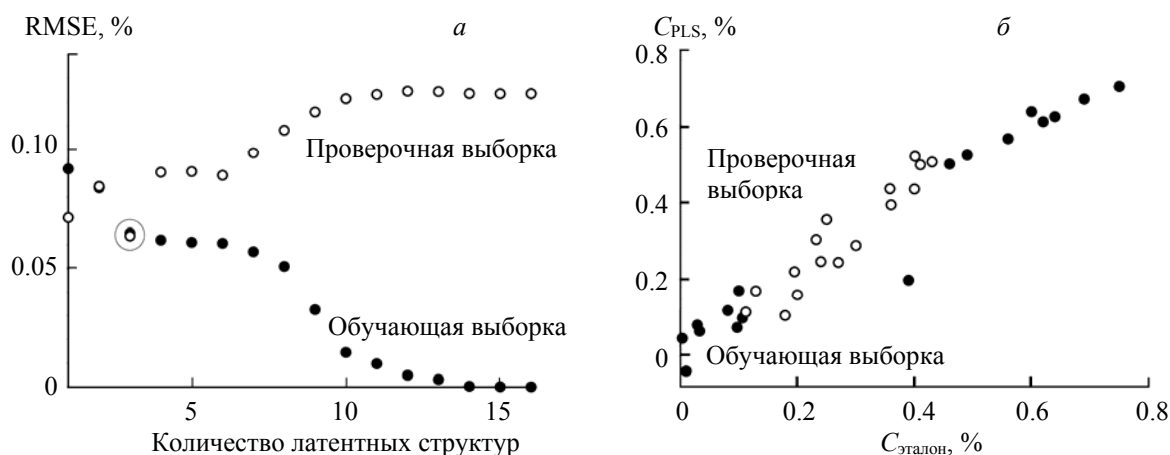
Рис. 2. Зависимости среднеквадратичного отклонения для калибровочных моделей содержания углерода (а) и соотношение между предсказанной с помощью PLS-модели и эталонной концентрациями углерода (б)
